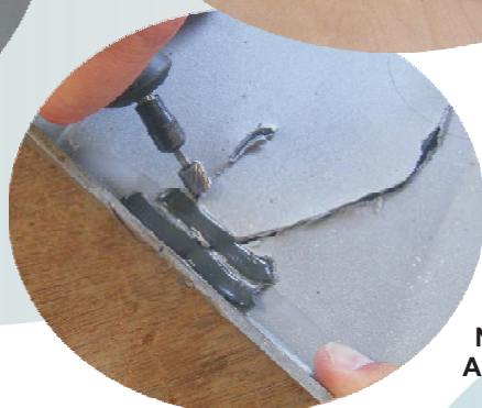
Frezowanie miejsca pęknięcia.
