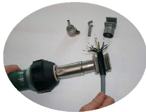
Obkurczanie koszulek termokurczliwych w branży samochodowej.
